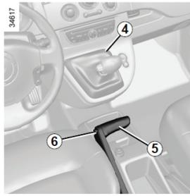
Wenn der Hebel trotz gedrücktem Bremspedal **beim Starten** in Position **P** blockiert ist, kann er von Hand gelöst werden. Hierzu die Hebelabdeckung ausrasten und gleichzeitig auf das Profil **4** und auf den Entriegelungsknopf **6** am Hebel drücken.
